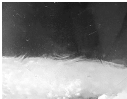
Obr. 3. Jev doprovázející rozpouštění cukru ve vodě. Díky rozdílné koncentraci při pomalém rozpouštění cukru vzniká gradient hustoty a dochází k pozorovatelnému ohybu světla
