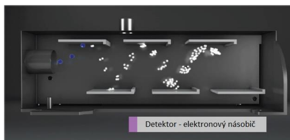
Obrázek 1. Elektronásobičový detektor – znázornění kaskády elektronů, která vede ke kvantifikaci iontů na základě impulsů.
