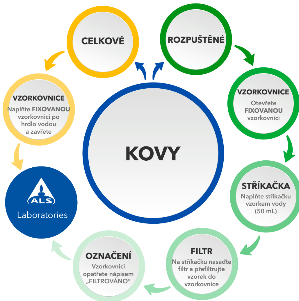
Obrázek 1. Grafické znázornění vzorkování vod před analýzou stopových kovů.
