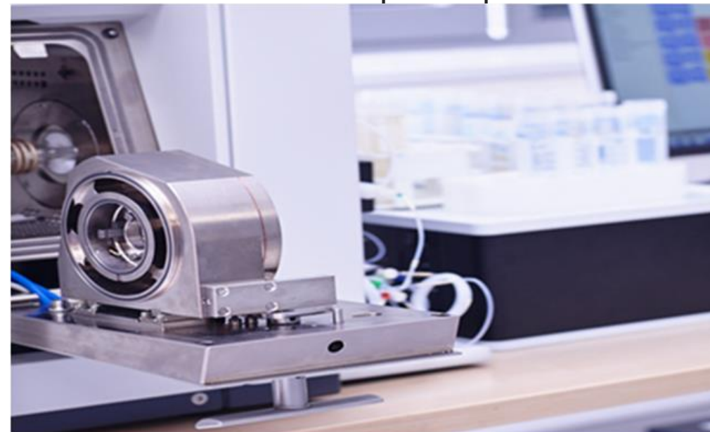
Plasma interface unique drop-down door
